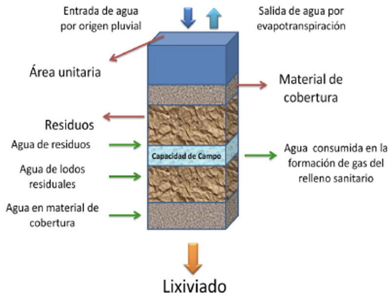
Ilustración 1: Esquema de definición para el balance hídrico utilizado para calcular la cantidad de lixiviado de un relleno sanitario
