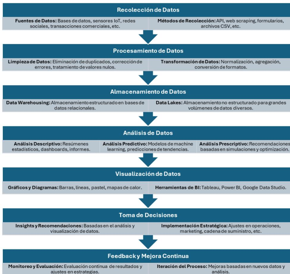
Figura 1. Etapas del proceso de la analítica de datos
