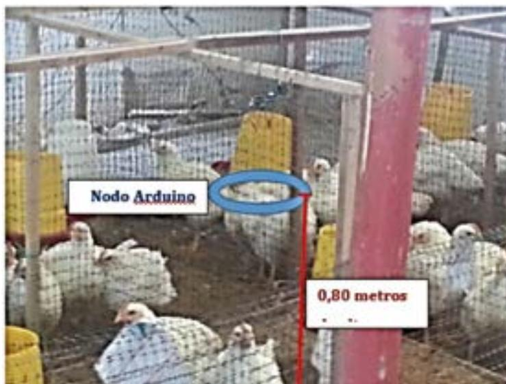
Figura 7. Colocación del módulo - altura
