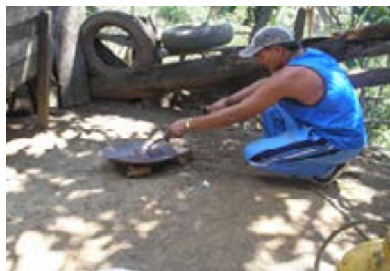
Figura 3. Quema de amalgama del metal con mercurio al aire libre. Fuente: autores.
