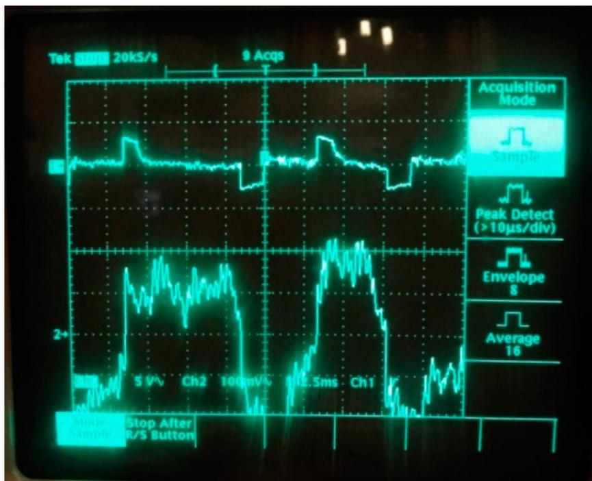
Figura 8. Medición del Sistema de mejoramiento de calidad auditiva para 90 dB.
